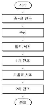
[고결정성 나노기공 이산화티탄 광촉매 제조 방법을 나타낸 공정 순서도]
