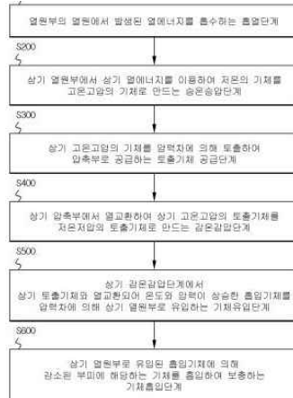
[압력차를 이용한 자연유도방식의 열교환방법의 일 실시예]
